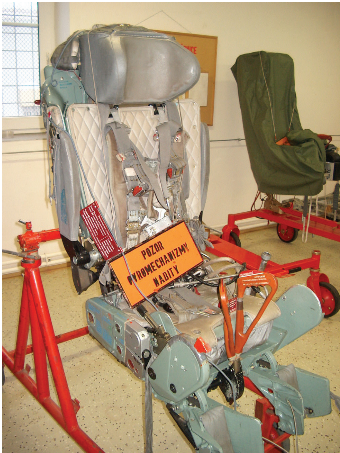
Celkový pohled na vystřelovací sedadlo KM – 1M demontované z letounu kvůli údržbě – výstražná cedulka varuje před dosud nabitými pyrotechnickými prostředky.
