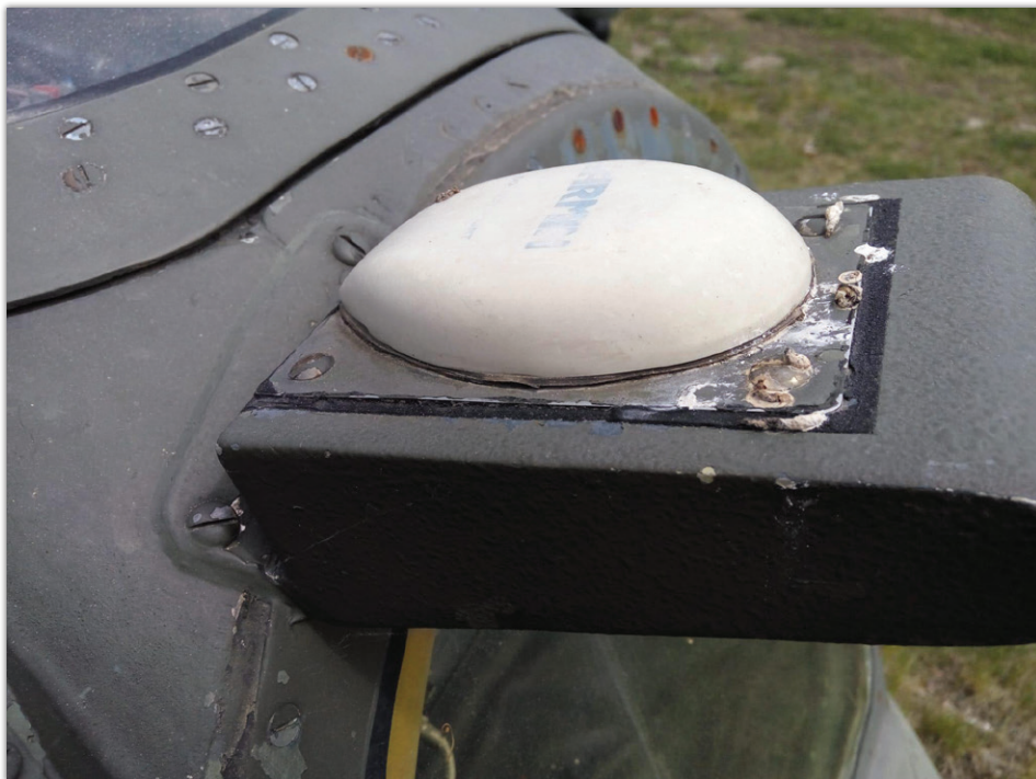
Detail antény systému GPS původní instalace, vyvinuté v leteckých opravách Kbely.
