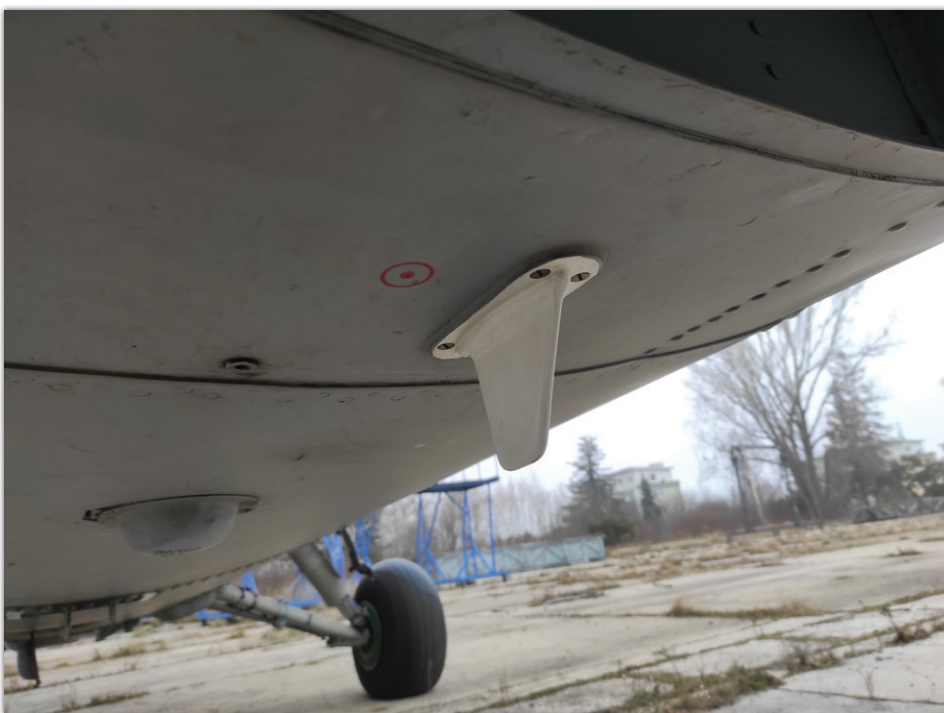
Antény palubního odpovídače APX-100 byly montovány za předovým podvozkem a na horní části ocasního nosníku.
