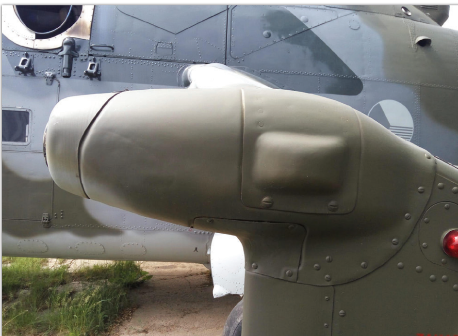
První várka „Věček“ měla ještě fotokulomet umístěn v kořeni levého křídla, jako tomu bylo u verze Mi-24D. Chybí již ale „bradavice“ výstražného radiolokačního systému S3M Sirena.
