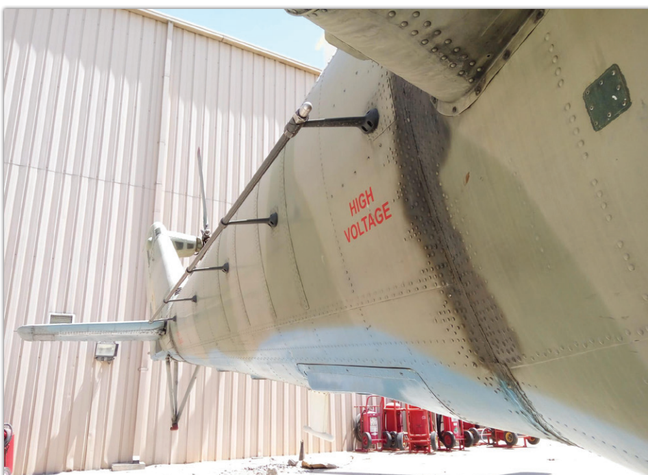
Viditelnou změnou na vrtulnících dodaných Afghánistánu byla trubková anténa 10-389 HF radiostanice, která byla namontována podél pravé strany ocasního nosníku.
