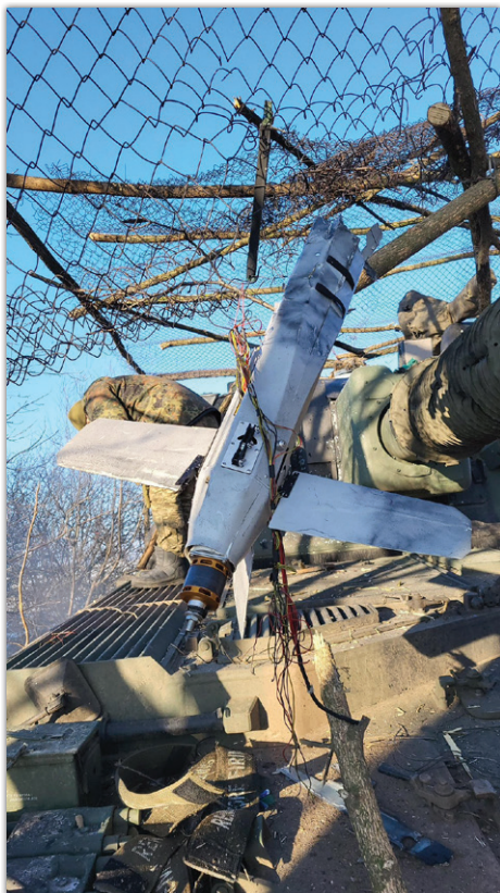
Samohybnú húfnicu Krab polskej výroby zachránilo pred ruským kamikadze dronom Lancet kovové pletivo.
